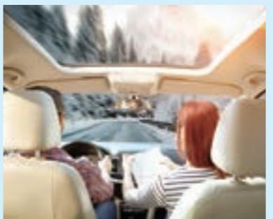
特殊な調光フィルムにより、瞬時に透過光をコントロールできます(スイッチオン時は透明、オフ時は不透明)。ルーフやパーテーションへの採用により、エレガントな空間を演出します。
