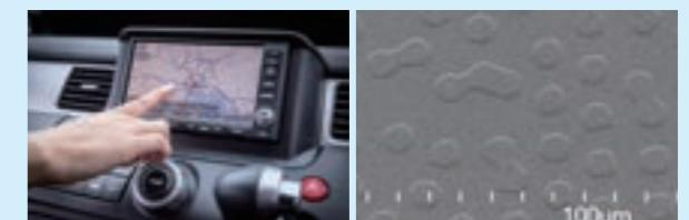
ガラス表面への独自加工技術を活用し、従来では実現できなかったクリアな見栄えと映り込みの抑制を両立。高解像度ディスプレイのギラツキ防止にも対応しています。
