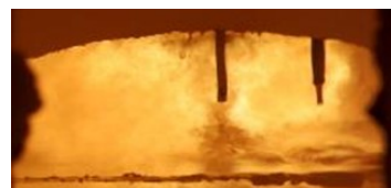
80%の天然ガスと20%の水素の燃料ブレンドを使用した炉内の火炎外観。
