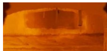
100%水素の燃料ブレンドを使用した炉内の火炎外観。
