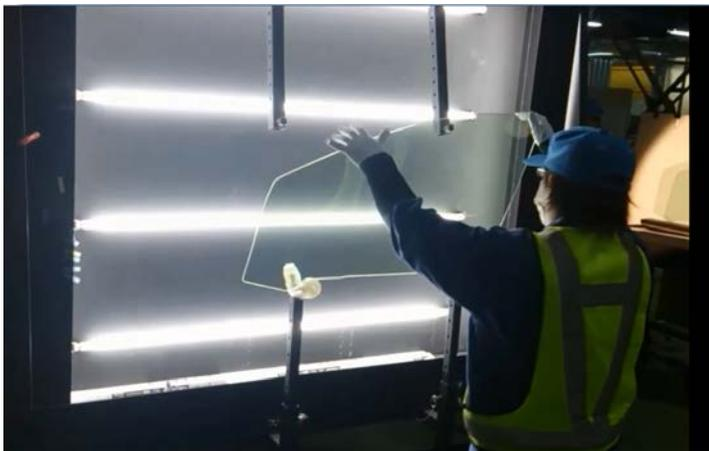
写真：既存紫外線カットガラスの検査工程
