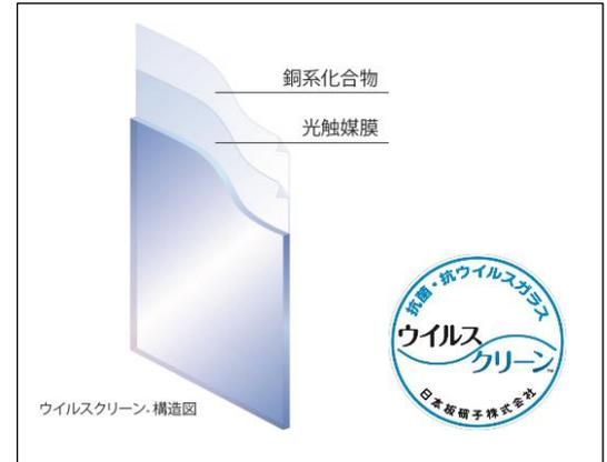
銅系化合物の抗ウイルス効果が弱まっても、光触媒機能によって効果が回復します。光触媒は屋外光（紫外光）により光触媒効果を発揮する「紫外光応答型」が一般的ですが、ウイルスクリーン®は蛍光灯や LED 照明の可視光にも反応する「可視光応答型」であり、室内で利用可能な抗ウイルスガラスとしてご利用いただけます。
