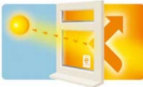
Low-E(低放射)ガラスは、片面に透明膜をコーティングした高機能ガラス製品です。熱が室内に反射されることで、熱が窓から室外へ逃げにくくなります。暖かい面(室内側)から冷たい面(室外側)へ熱を伝わりにくすることで、窓から室外へ流出する熱量をさらに抑えます。コーティングを施しても、大量の日射エネルギーは室内に採り入れられ、暖房効果が得られます。
