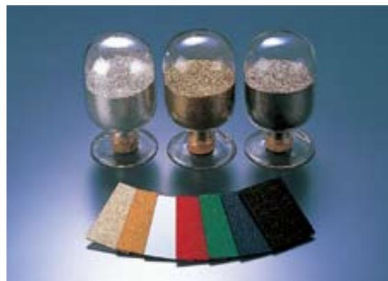
メタシャイン®は表面平滑性の高い「ガラスフレーク®」に金属・金属酸化物を被覆させた光輝性に優れた顔料です。メタシャイン®を塗料・樹脂へ添加、コートすることにより優美で鮮やかな色調が得られ、独自の金属光沢を実現させることができます。自動車から電気製品・携帯電話、インキ、化粧品まで多彩な分野で活躍しています。
