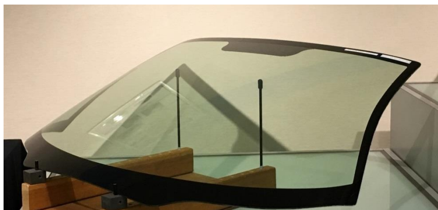
高精度プレス工法で製造した複雑造形のフロントガラス
